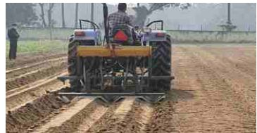
ट्रैक्टर चालित बेड प्लान्टर द्वारा मेढ़ पर मक्का की बुआई
