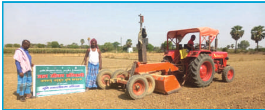
नालंदा के हरनौत ब्लॉक के सरथा ग्राम में लेजर लैंड लेवलर का प्रत्यक्षण
